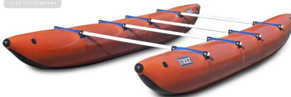
Катамаран четырёхместный "Зилим-4ПВХ" является разборным надувным спортивно-туристским судном. Катамаран предназначен для путешествий и отдыха на воде. Конструкция гондолы - однослойная (моно баллон), двухсекционная, цельно склееная из очень крепкой на разрыв синтетической, воздуходержающей ткани с двухсторонним ПВХ-покрытием.
